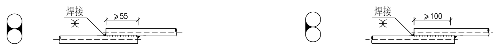
图1. 接地钢筋双边焊接, 搭接长度不小于55mm, 焊缝厚度不小于4mm。 图2. 接地钢筋单边焊接, 搭接长度不小于100mm, 焊缝厚度不小于4mm。
